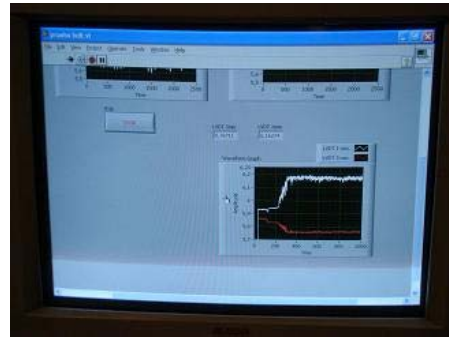
Fig. 2 Pantalla de LabView con la adquisición de datos de los LVDTs.
