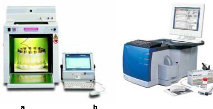
Figura no. 25. Nuevos diseños en equipo para síntesis orgánica con microondas para laboratorio, a).- el más sencillo de carusela para la enseñanza y b).- uno más completo para investigación básica.
