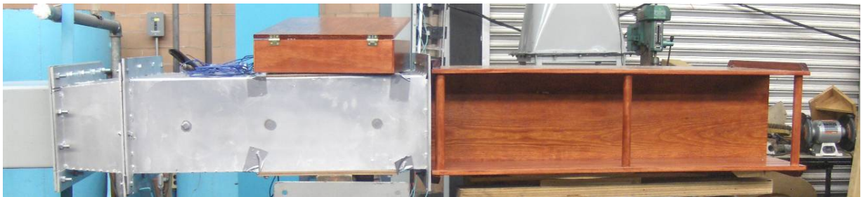
Figura 1.11. Montaje de sección de pruebas.
