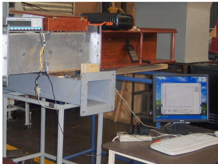
Figura 1.27. Conexión física del sistema de mediciones de temperatura.
