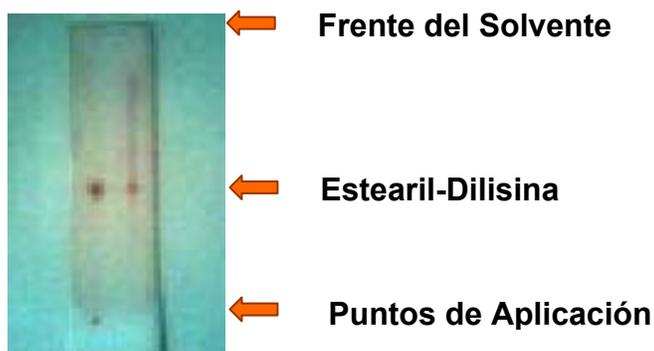
FIGURA 2. CROMATOGRAFÍA EN PLACA FINA EN SILICA GEL DEL LÍPIDO ESTEARIL-DILISINA.
